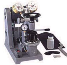
破裂強度試驗
